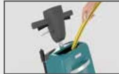
**Schmutzwassertank spülen; Tank zum Trocknen geöffnet lassen**
